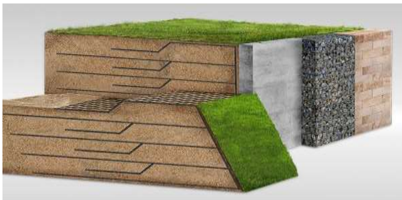
Figure I-21. Le renforcement par inclusions géosynthétiques
