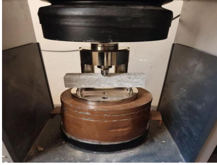
الصورة رقم (2-IV) : آلة التحطيم الخاصة تجربة الانحناء
