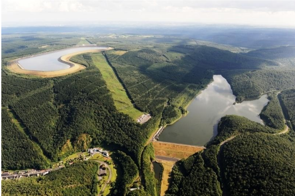
Figure 02 : La STEP de Revin dans les Ardennes, réservoirs de 7 millions de m 3 , dénivelé 230 m (puissance jusqu'à 800 MWh), source [11]
