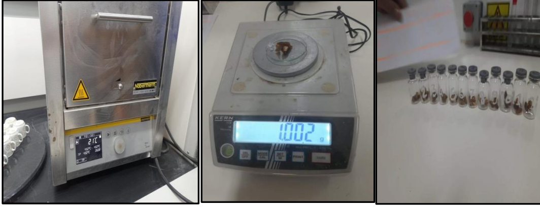
الوثيقة رقم 24: توضح طريقة قياس نسبة المادة المعدنية
