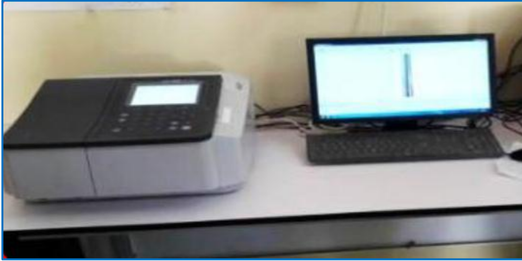
الشكل (II. 15): جهاز التحليل الطيفي (UV-VIS).
