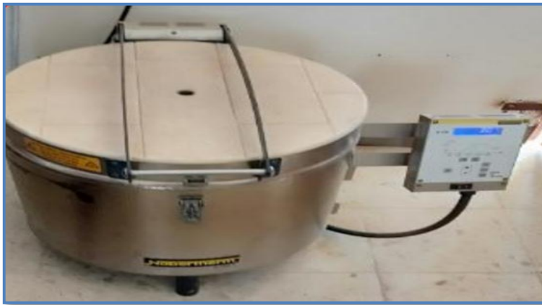
الشكل (4.III): يوضح الفرن المستعمل في المعالجة الحرارية.
