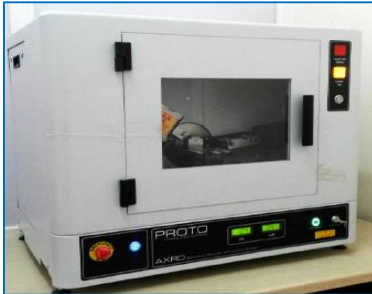
الشكل (12.11): جهاز إنعراج الأشعة السينية (XRD) المستخدم .
