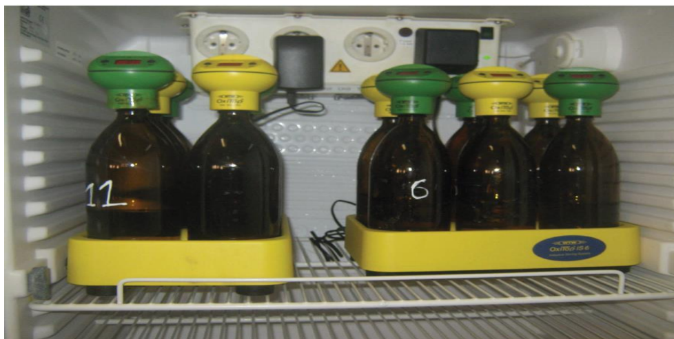
Photo.26 : DBO mètre pour la détermination de DBO 5 .
