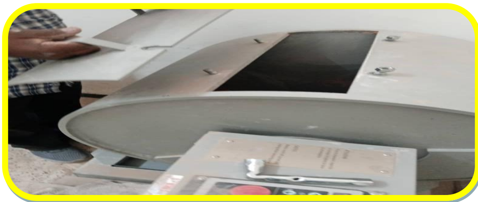
Photo III.6 :Machine d'abrasion Los Angeles (labo M. bachir)
