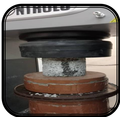
Photo (III 17):La machine pour essai de compression et affichage de la résistance (laboratoire degénie civile)
