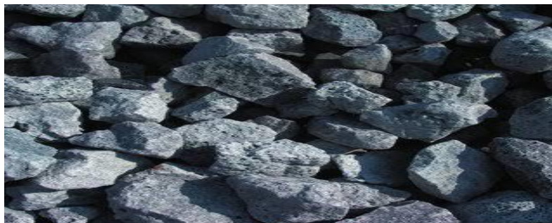
photo I.8. Photo d'un laitier d'acier.
