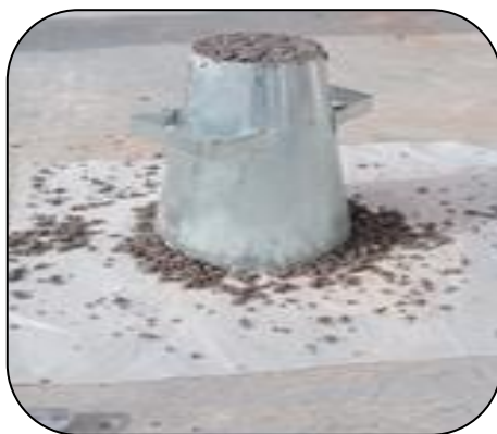
Photo(III.10):l'affaissement de cône d'Abrams d'un béton.(zone industriel el_oued)
