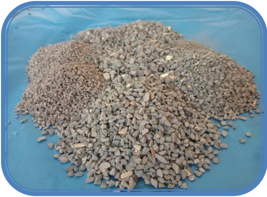
Photo III 1 : déchet de béton 'DBR' (laboratoire de G.C)
