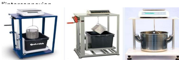
Photo (III 14):appareille de pesée hydrostatique(labo mahmoudébachir)
