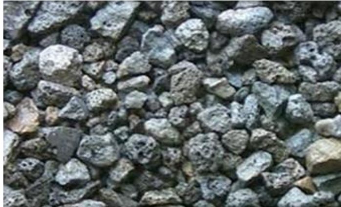
photo I.7. Photo d'un laitier de haut fourneau.
