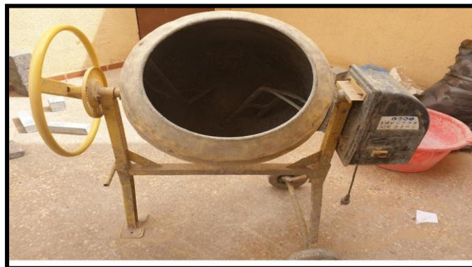
Photo(III.9) :Le malaxeur utilisé (zone industriel el_oued).
