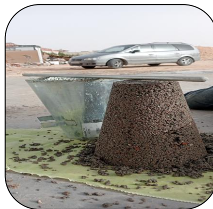
Photo(III.10):l'affaissement de cône d'Abrams d'un béton.(zone industriel el_oued)
