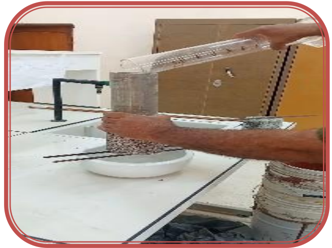
Photo (III 16): essai de la perméabilité (laboratoire génie .civile )
