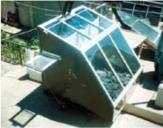
Séchoir solaire de type direct
