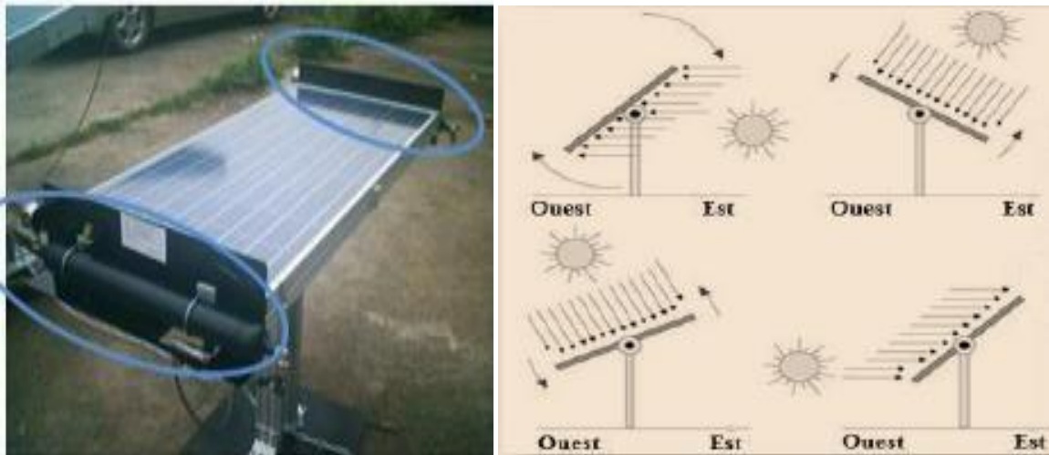
Figure II.12 : Exemple et fonctionnement du suiveur passif [2]
