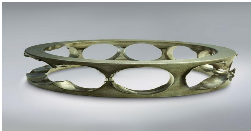
Figure II.10. Déformation de cage d'un roulement à billes de contact angulaire [BEN18].
