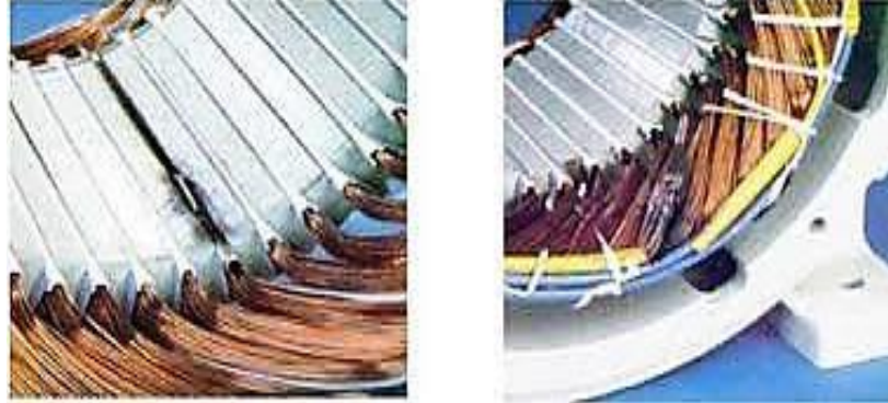
Figure I.7. Court-circuit entre phases [MER20].
