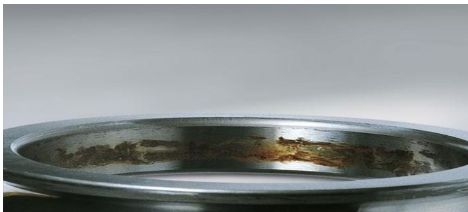
Figure II.8 . Corrosion de contact sur la bague Intérieure d'un roulement à rouleaux Sphérique [BEN22].
