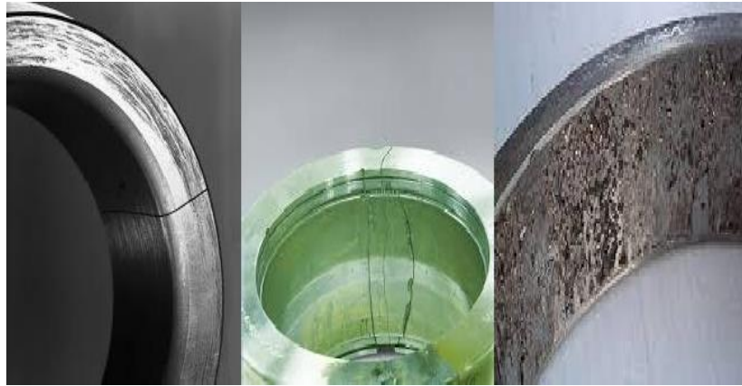
Figure II.11: Fissure (cassure) et piquetage dans la bague extérieure.
