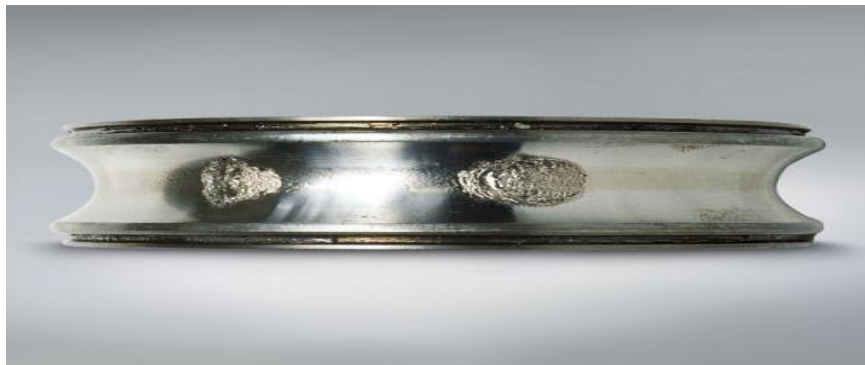
Figure II.7. Photo d'un écaillage de fatigue d'un roulement sur la BE [BEN18].
