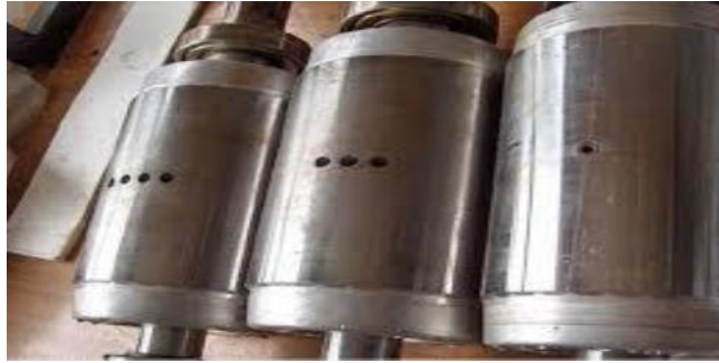
Figure I.11. Défaillance rupture des barres de rotor.
