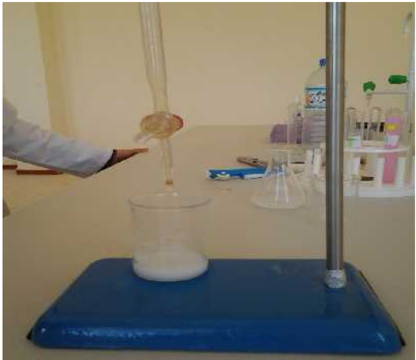
Le mécanisme de titrage d'acide lactique a la présence de hydroxyde de sodium .
