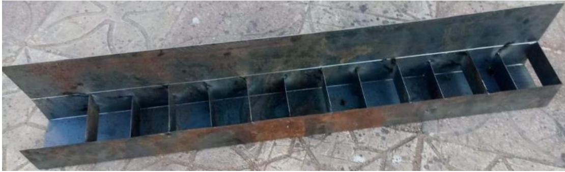
Figure III-9: Récepteur de concentrateur cylindro-parabolique
