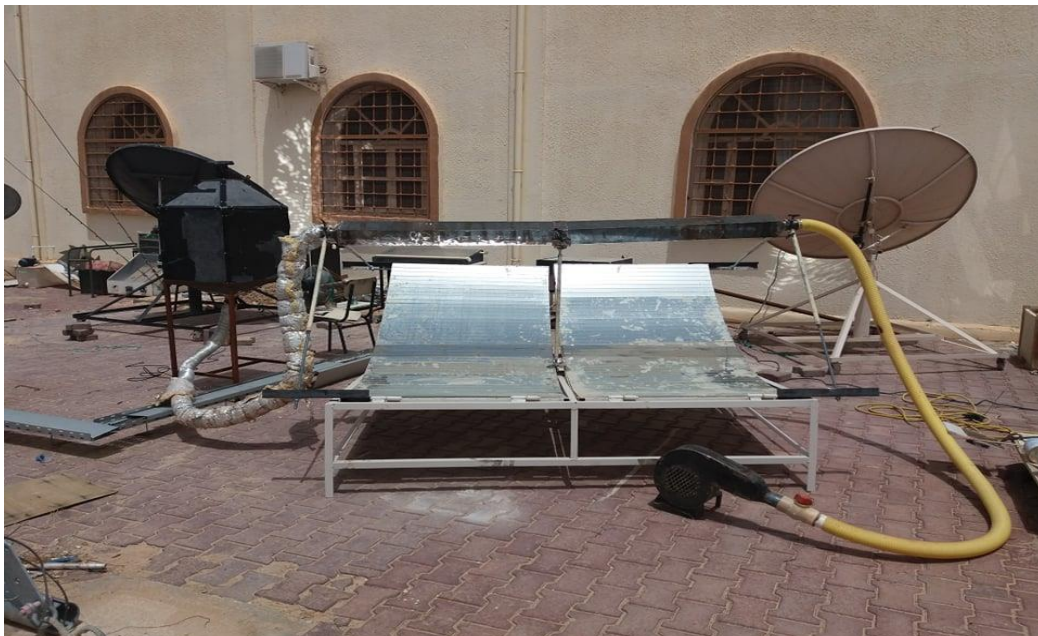
Figure III-7: Séchoirs solaires cylindro -parabolique
