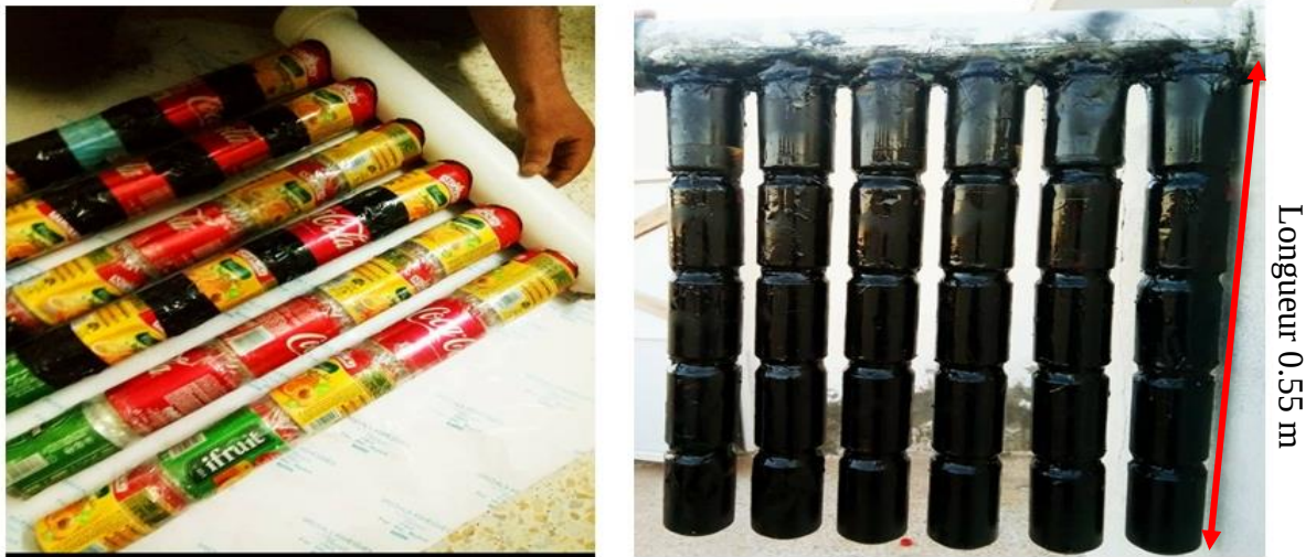
Figure III.7 : Les tubes en aluminium avant et après la Peinture
