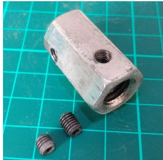
Figure 24. Raccords moteur axe
