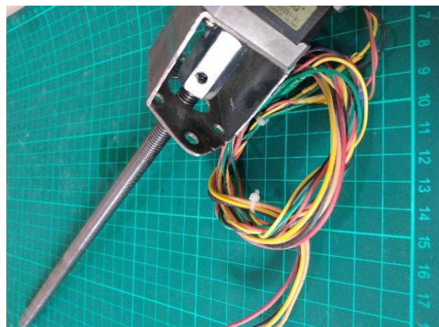
Figure 25. Montage moteur axe
