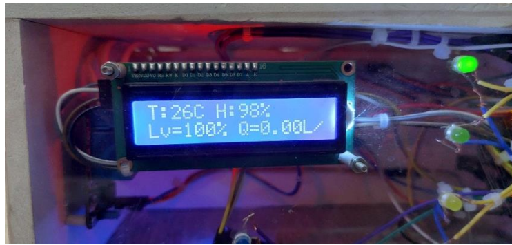
Figure (III.17) : Résultat : Liquide dans le réservoir contient 100%
