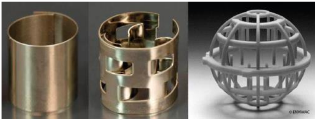
Figure III-7: Raschig-Ring, Pall-Ring et ENVIPAC: éléments de garnissage de 1ère, 2ème et 3ème génération.
