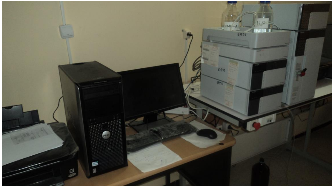
صورة لجهاز كروماتوغرافيل سائلة عالية الاداء HPLC
