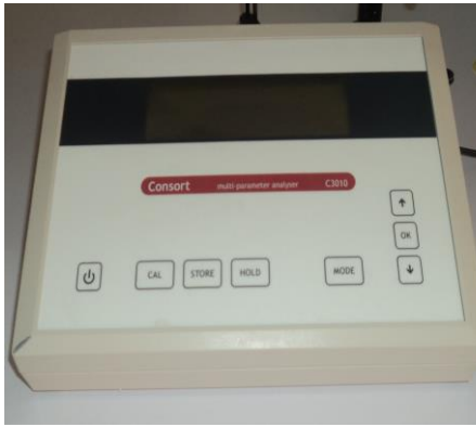
الشكل (III-6): صورة توضح جهاز Hp متر
