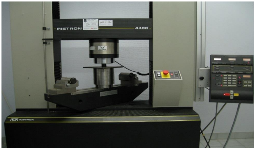
Figure I.6.4 : Une machine renforcée et un capteur de force de capacité élevée.
