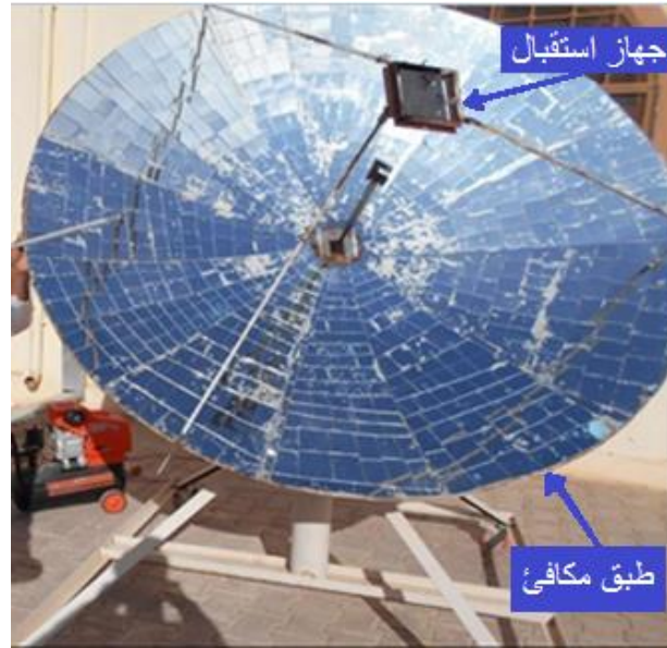
الشكل (I-5): يبين طبق مكافئ وتوضع جهاز الاستقبال في نقطة التركيز. [11]
