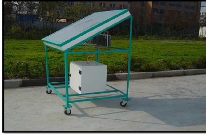
الشكل (3-I): آلة التبريد الشمسي الامتزاز [10]
