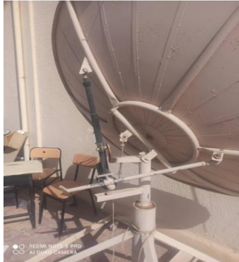
الشكل (5-II): نظام التتبع الشمسي المستخدم
