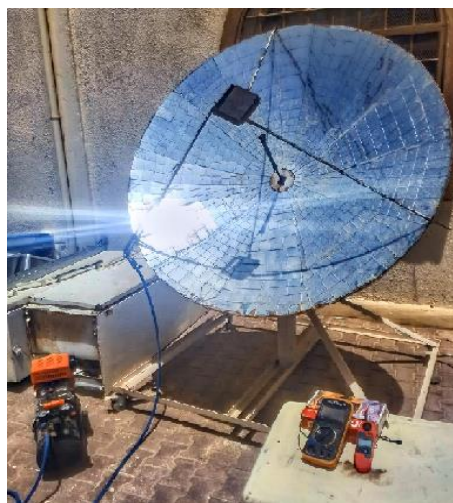
الشكل (II-1): التجميع الكامل للفرن الشمسي المستخدم
