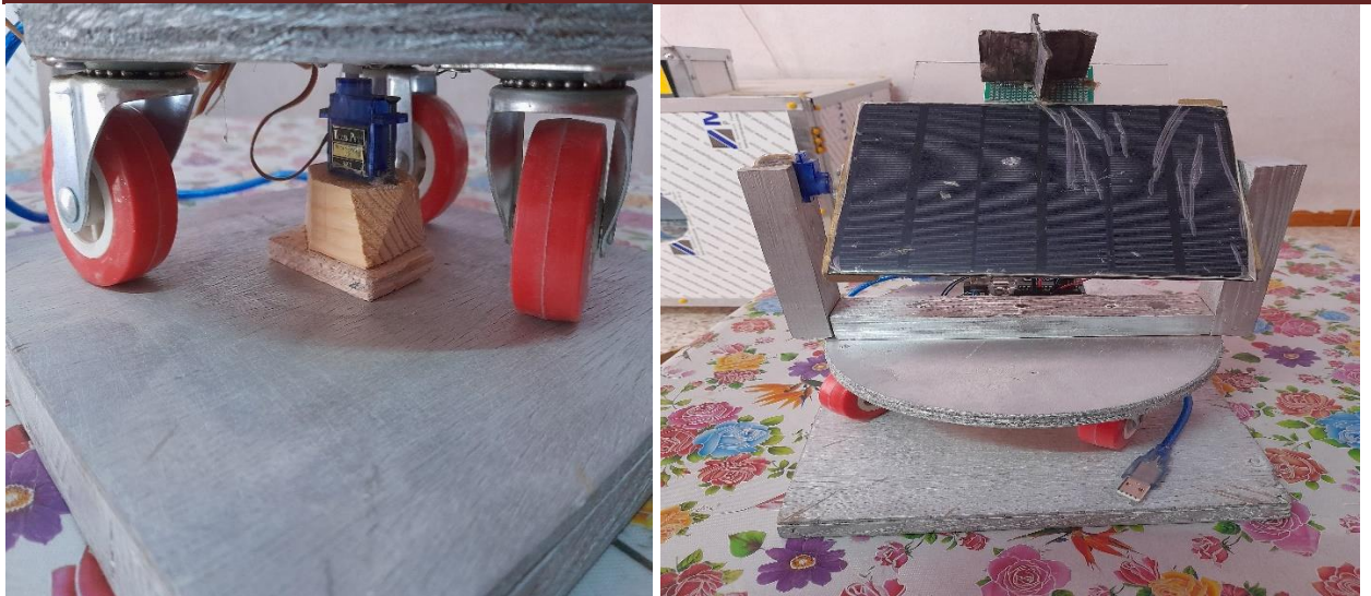
Figure III (8) : Structure du châssis du tracker
