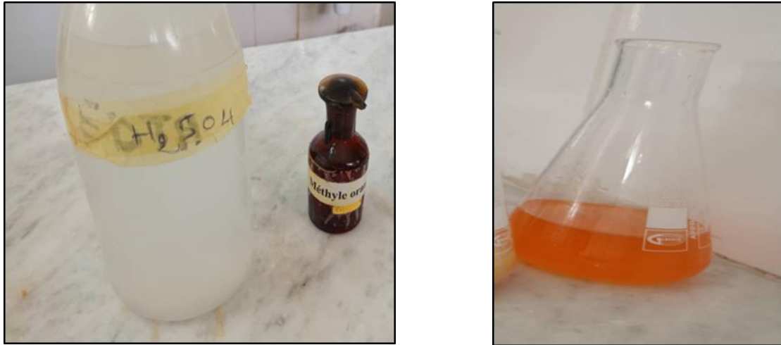
Figure.II.04 : Matériel utilisé et virage de couleur lors de la titration du TAC.
