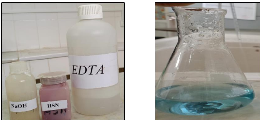
Figure.II.02 : Titration du calcium ( Ca^{+2} ) .
