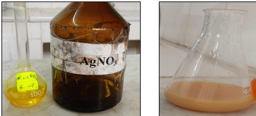
Figure.II.03 : Dosage du chlorure ( Cl^- ) .
