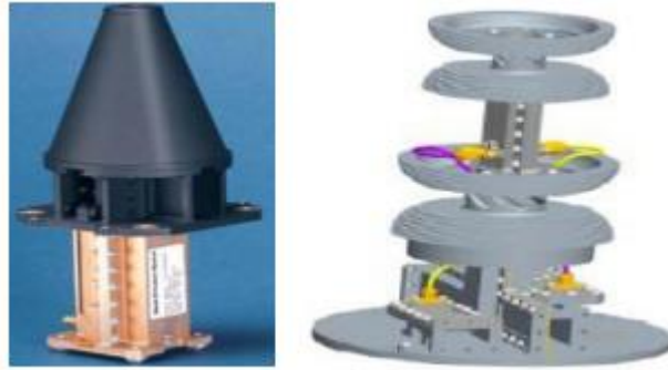
Figure I-5 : Antenne de télémétrie, poursuite et de commande
