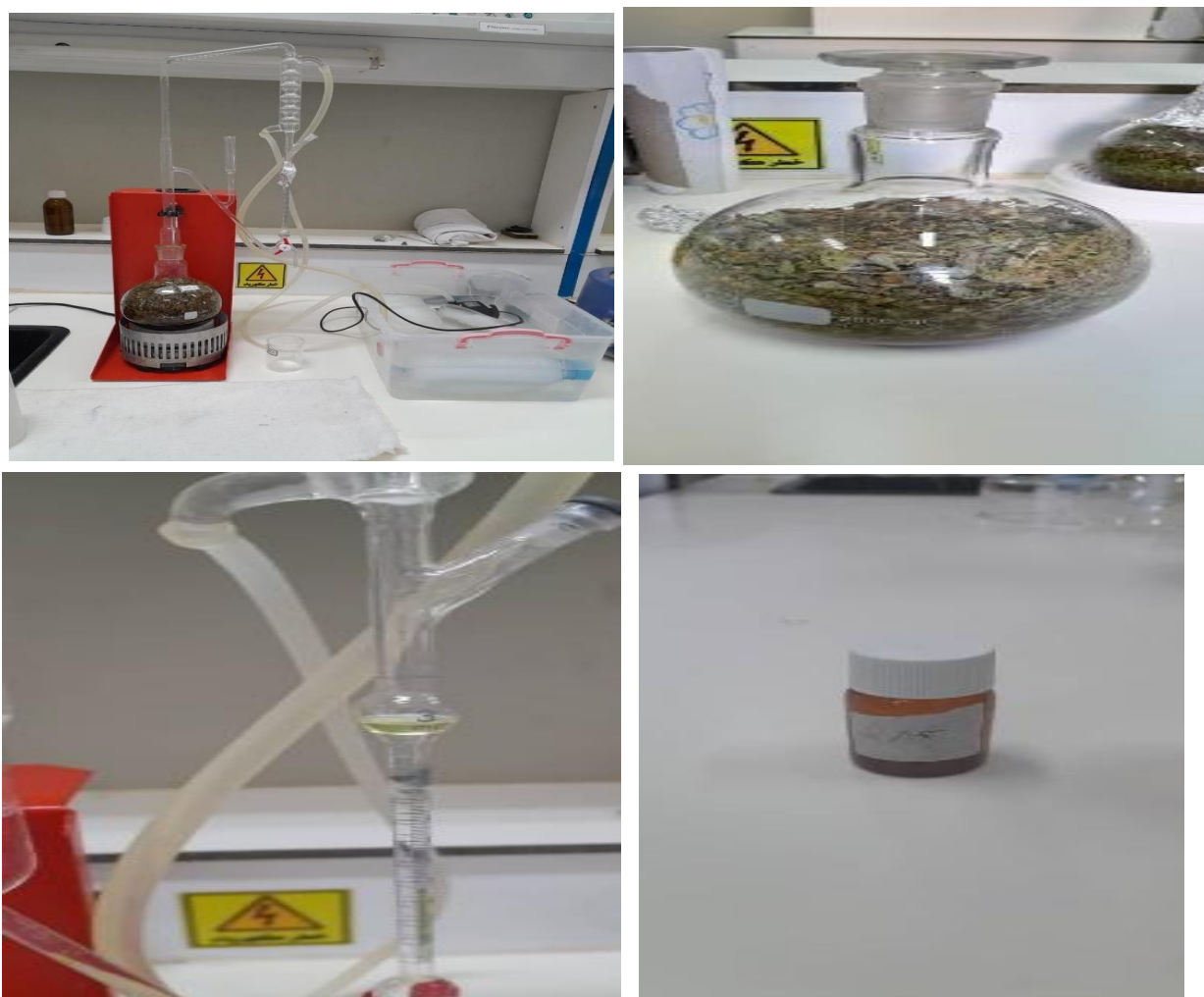
Figure13- Montage d'extraction de l'huile essentiel (Originale, 2024).
