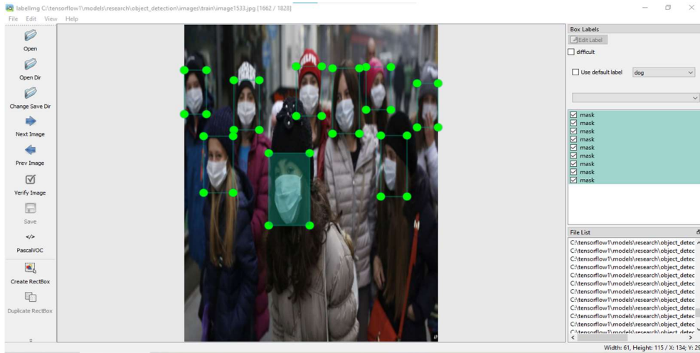
الصورة 26.3: عملية تسمية و تصنيف الصور بواسطة أداة LabelImg للصور المنزلة
