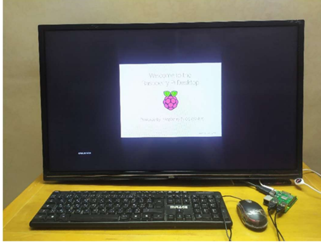
الصورة 40.3: توصيل Raspberry pi بالشاشة
