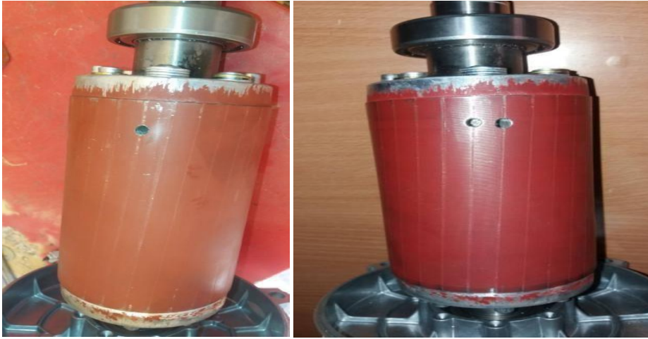
Figure (III.1): Photographie des rotors de la MAS de 3 kW pour une barre cassée(gauche) et avec deux barres cassées (droite).
