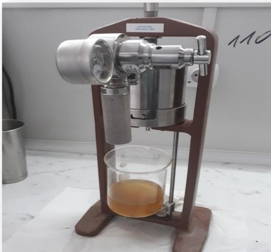
Fig. 30 : Cellule de filtration API (photo personnelle, 2018).
