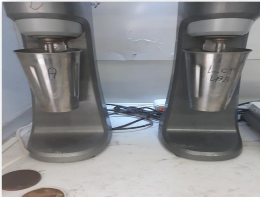
Fig. 29 : Préparation des colmatants dans l'homogénéisateur Hamilton Beach (photo personnelle, 2018).
