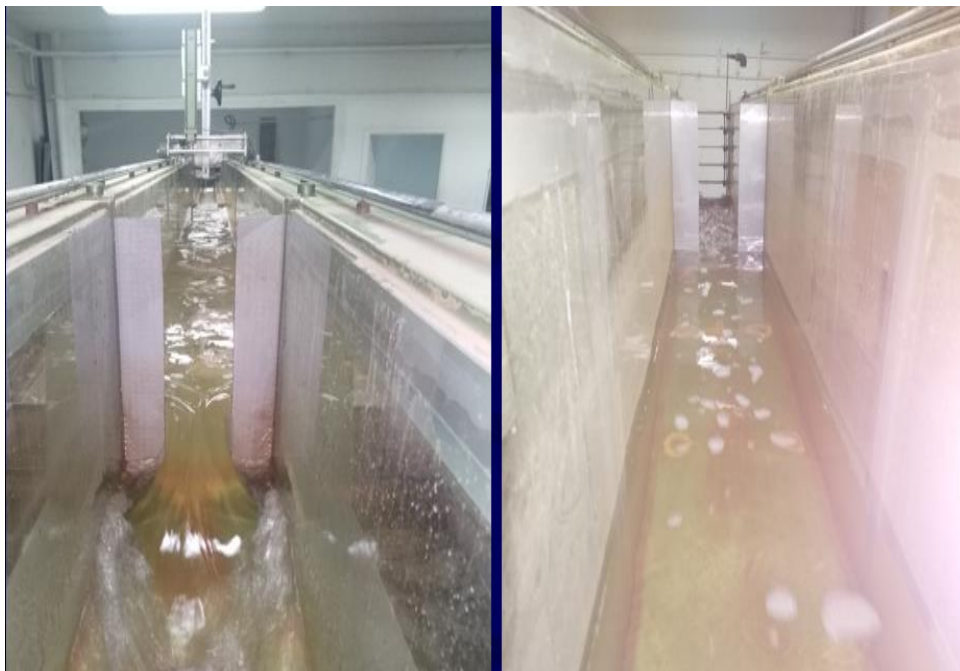
Figure 1.4: Photographie du déversoir rectangulaire avec contraction latérale pour mesurer les débits pompés(Laboratoire Université Ouargla).
