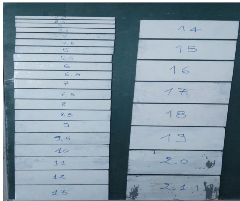
Figure 1.8: Photographie des parois de contrôle du ressaut(Laboratoire Université Ouargla).
