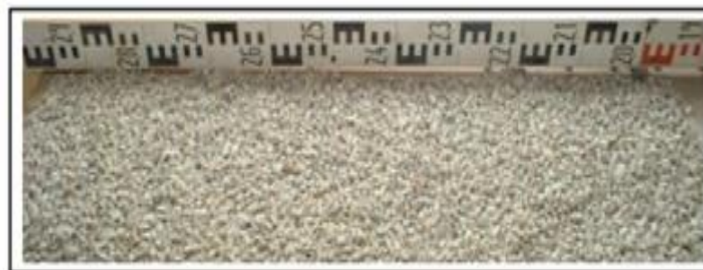
Figure 3.1 : Echantillon de toile rugueuse de rugosité absolue \varepsilon = 8,73\text{mm}
