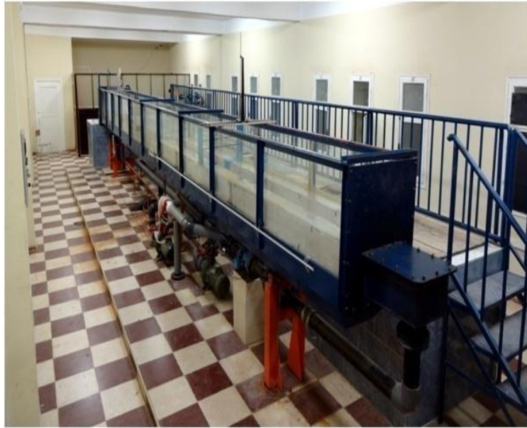
Figure 2. 2: Photographie du canal ayant servi à l'expérimentation (laboratoire larhyss de Biskra)
