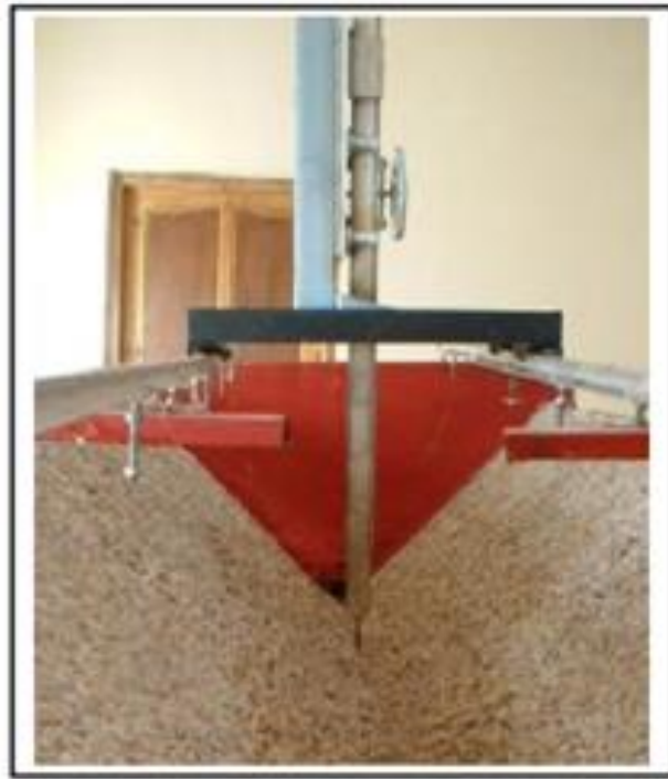
Figure 3.2 : Toile rugueuse soigneusement collée sur les deux parois du canal triangulaire
