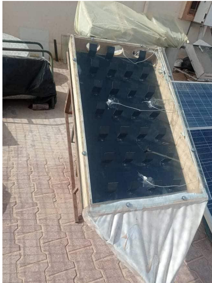
FIGURE III .12: Positionnement des capteurs de mesure (Deuxième expérience)
