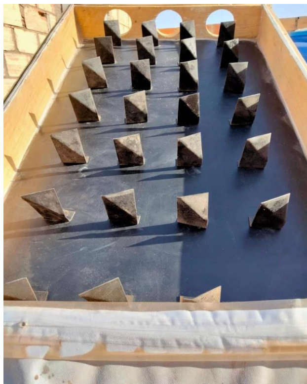
FIGURE III .3: Forme et emplacement des chicanes étudiées.
