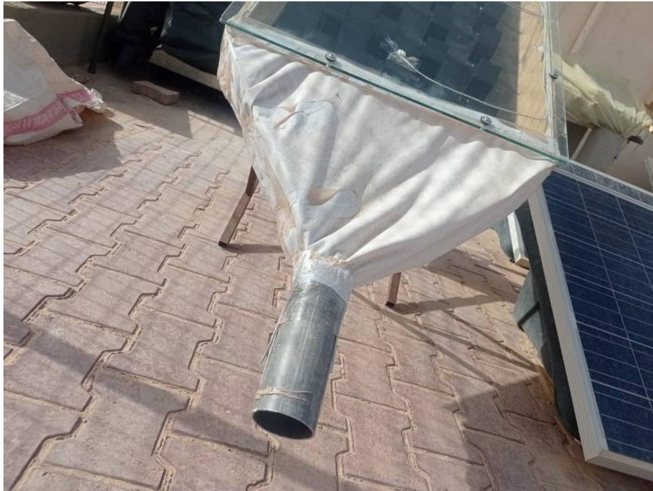
FIGURE III .5: Vue globale du conduit conique (collecte d'air)
