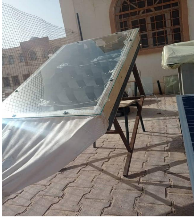
FIGURE III .9: Capteur solaire muni des chicanes (prés pou utilisation)
