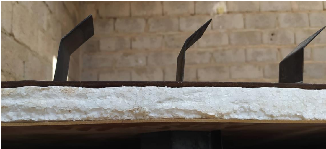
Figure III .1: Isolation thermique du capteur plan à air
