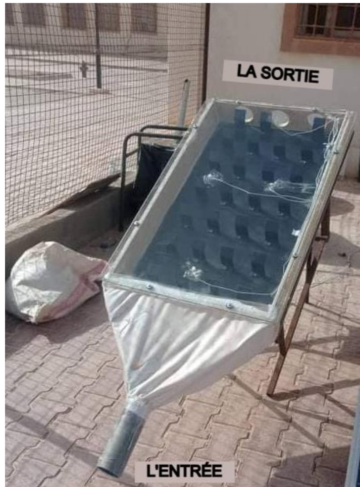
FIGURE III .2: Isolation thermique des longueurs d'entrée.
