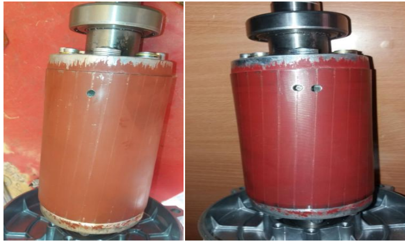
Figure (III.2): Photographie des rotors de la MAS de 3 kW pour une barre cassée (gauche) et avec deux barres cassées (droite).
