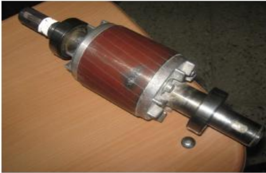
Figure (I.13): Présence la cassure de barre dans le rotor de la MAS [11].
