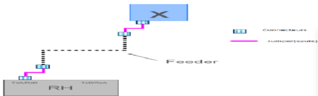
Figure III.2: Connexions du système d'alimentation de l'antenne. [28]
