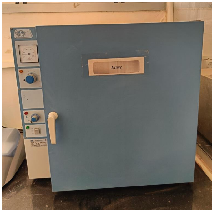
Photo 16 : Etuve chauffé (105°C) de marque « P SELECTA »
