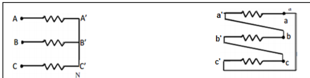
Figure( I.9) Couplage des enroulements des transformateurs.
