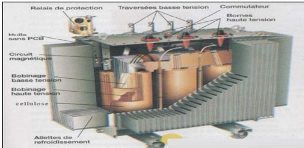
Figure (I.7) éléments d'un transformateur de puissance
