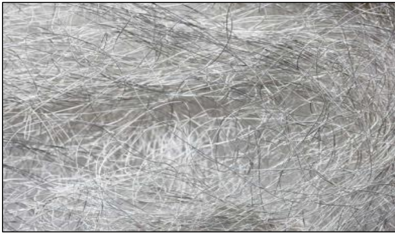
الشكل ( I - 10 ) : صورة ميكروسكوبية لأسلاك نانوية مصنوعة من السيلكون [8]
