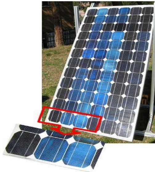
Figure III-10: défaut de revêtement anti –refle[29]
