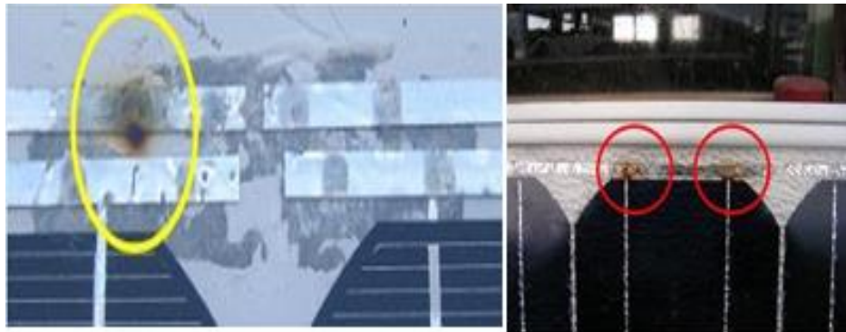
Figure III-9: défaut d'augmentation de la résistance Rs.[29]
