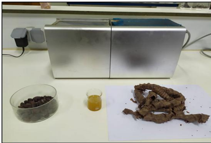
Figure 06: Extraction d'HF de jojoba par machine de pression à chaud (Photo originale).
