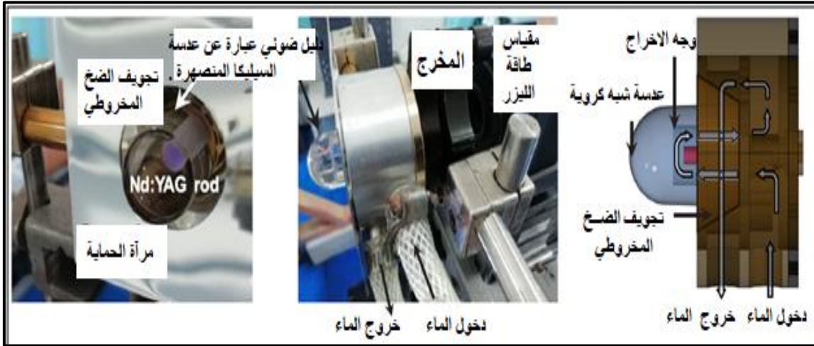
الشكل(16.2): منظر أمامي و جانبي لرأس الليزر الشمسي مع مرآة حماية مع دليل ضوئي عبارة عن عدسة من السيليكا وتجويف الضخ المخروطي[30].
