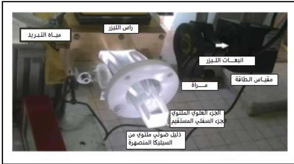
الشكل(14.2): نظام الليزر الشمسي لاستخراج طاقة الليزر المستقرة TEM 00 [27].
