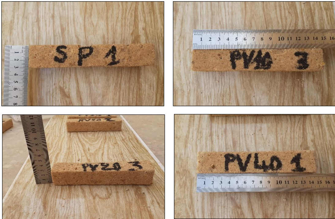
Figure III.13. Examen visuel des échantillons exposé à 5% de (HCl) après 60 jours.
