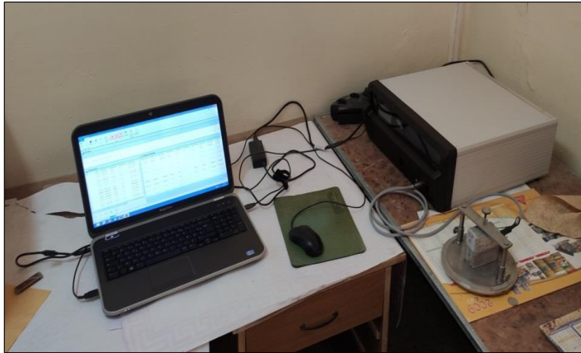
Figure II.13. Procédé de l'essai de la sonde Hot Disk TPS.
