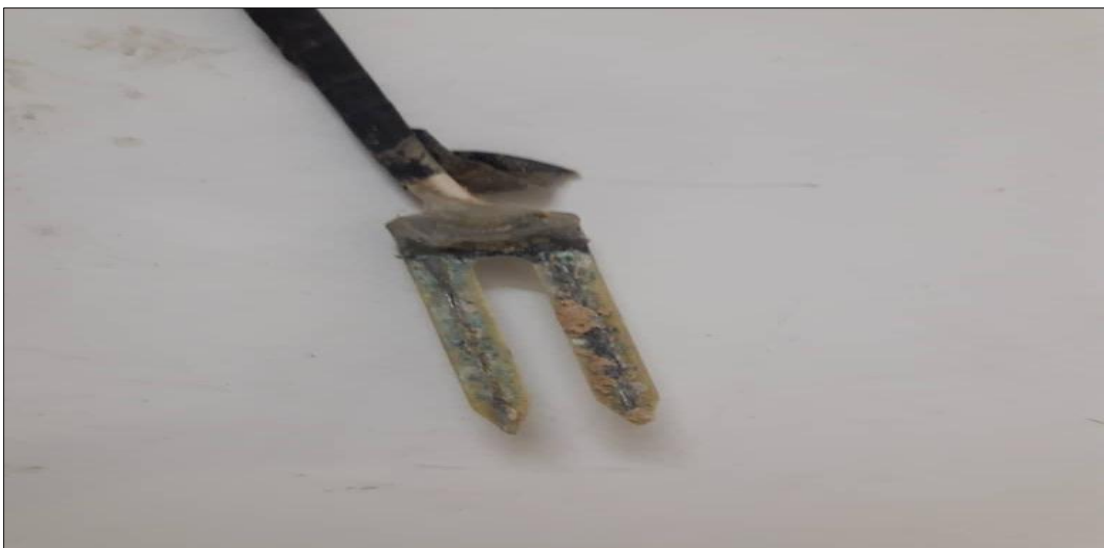
Figure 20: photo montre le sond d'humidité électrique.
