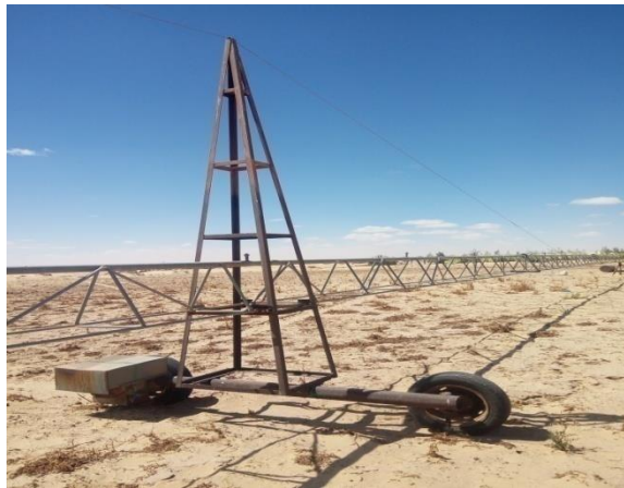
Figure I. 3 Tours mobiles sur pivot d'irrigation traditionnelle.
