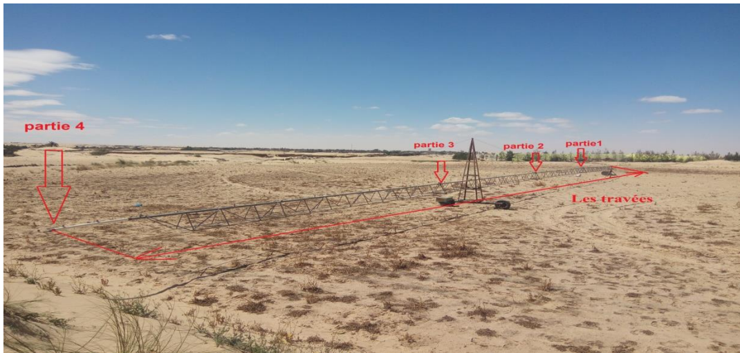
Figure I. 4 le travée de pivot d'irrigation traditionnelle
