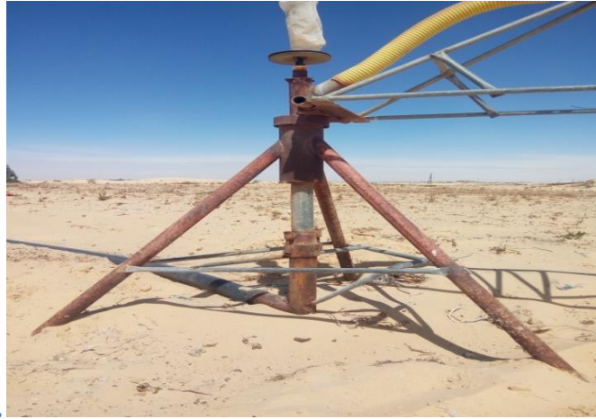
Figure I. 1 Elément centrale sur pivot d'irrigation traditionnelle
