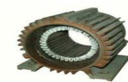
Moteur équipé de ses isolations d'encoche
