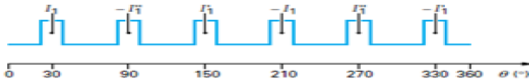
Figure I.9 Bobinage triphasé bipolaire : répartition spatiale des courants
