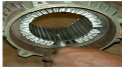
montage d'une isolation d'encoche
