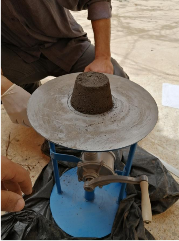
الملحق رقم 7: صورة توضح نهاية تجربة قياس التشغيلية.
