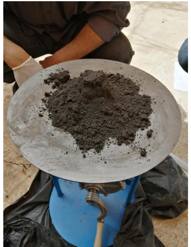
الملحق رقم 7: صورة توضح نهاية تجربة قياس التشغيلية.
