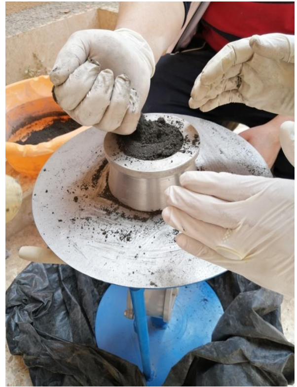
الملحق رقم 7: صورة توضح نهاية تجربة قياس التشغيلية.
