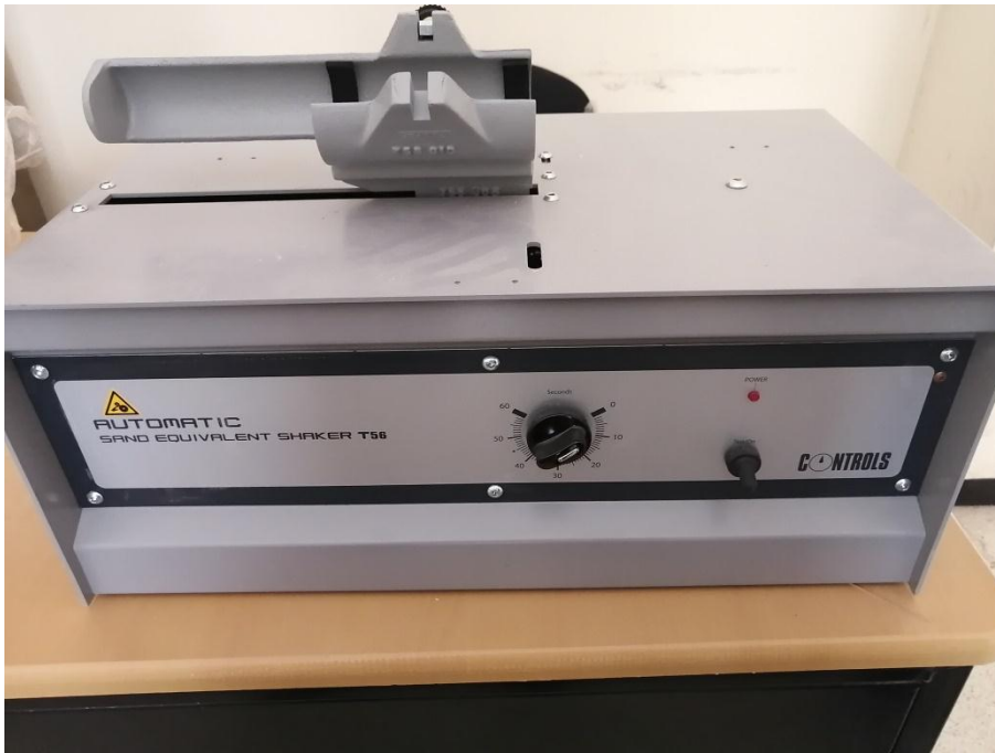
الملحق رقم 4: صورة توضح جهاز اهتزاز عينة تجربة المكافئ الرملية.
