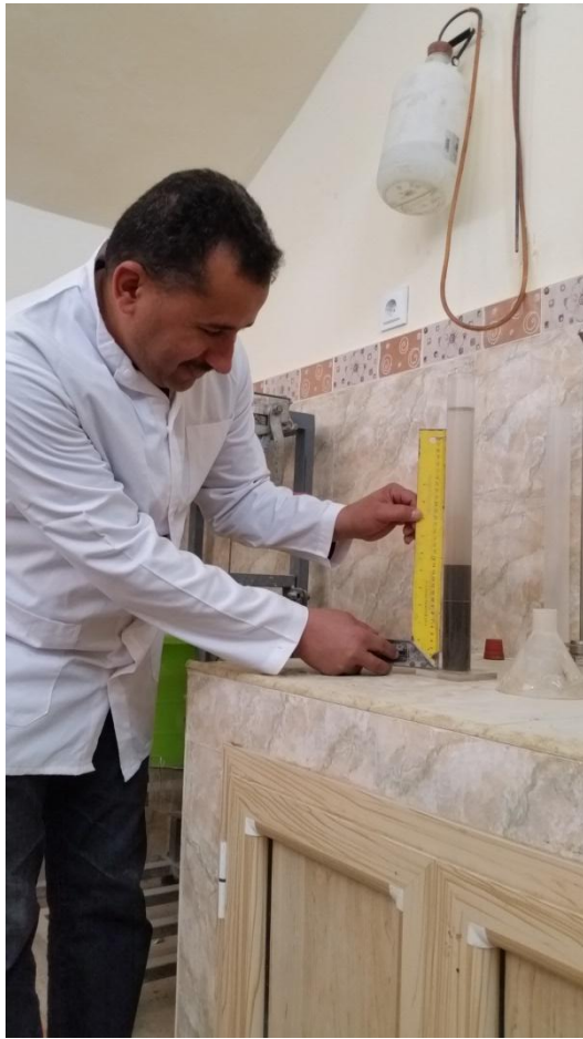
الملحق رقم 3: صورة توضح تجربة المكافئ الرملي.
