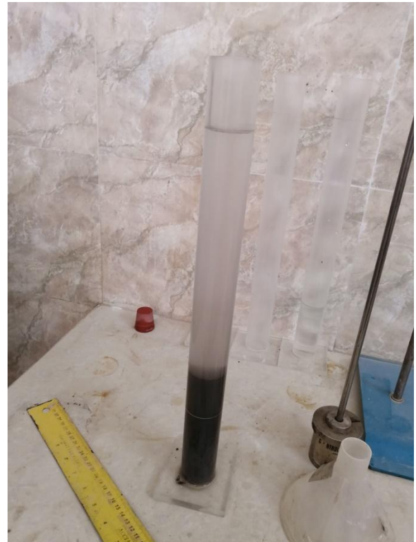
الملحق رقم 3: صورة توضح تجربة المكافئ الرملي.
