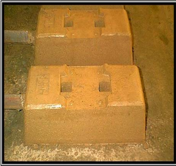
الشكل 3.II: العوارض بخرسانة الرمل مصنع بني صاف [14].
