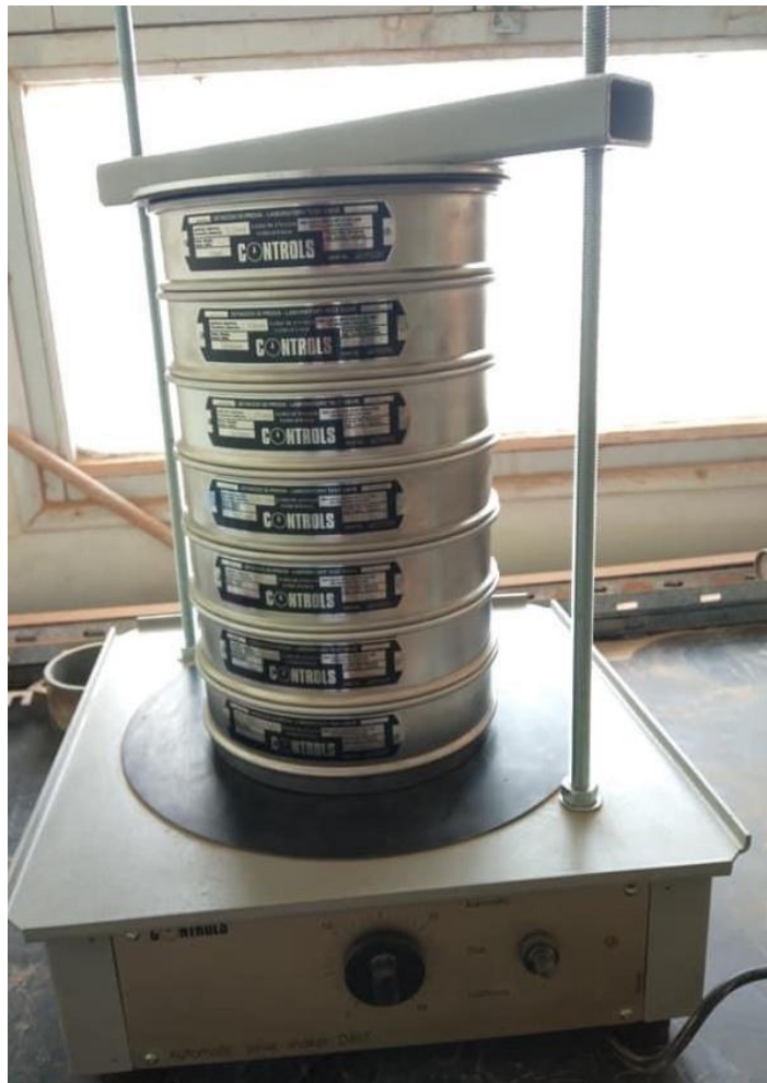
الملحق رقم 5: صورة توضح تجربة التدرج الحبيبي.
