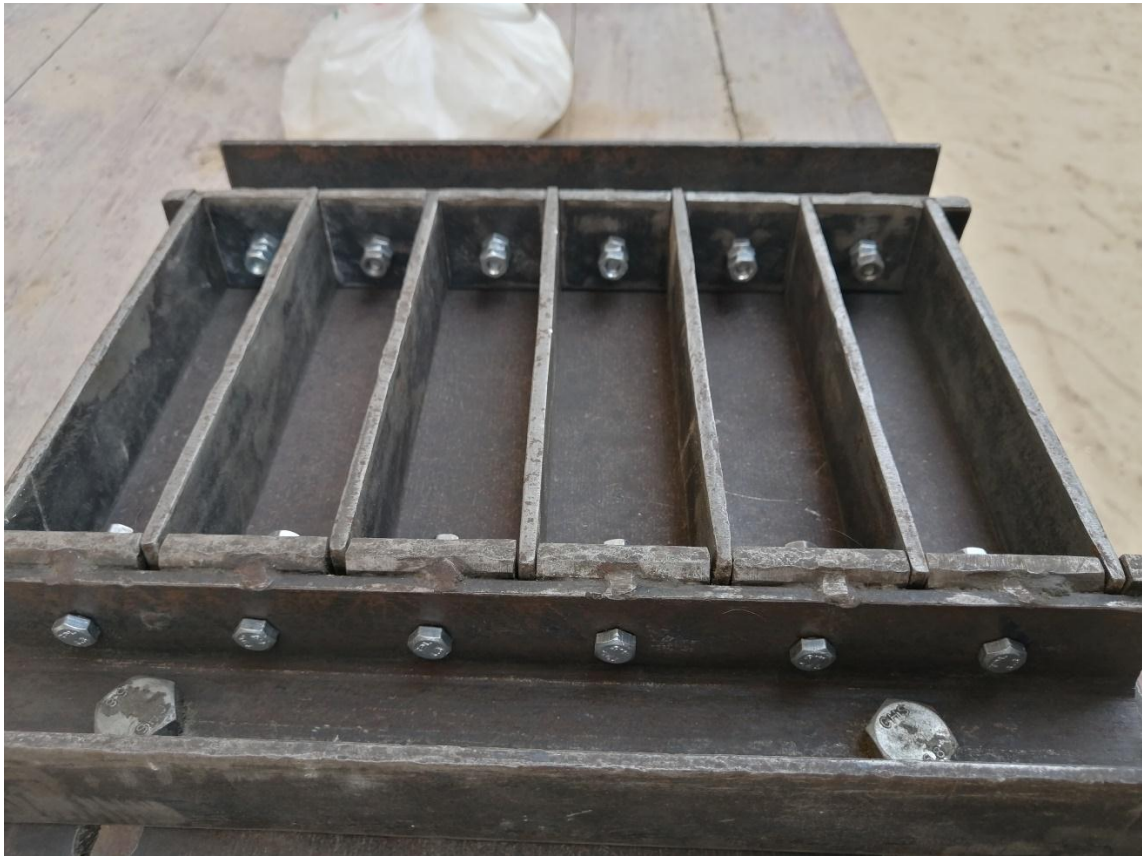
الملحق رقم 12: صورة توضح عينات خاصة بتجربة قياس الانكماش.
