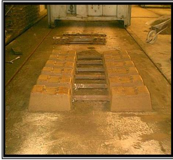
الشكل 3.II: العوارض بخرسانة الرمل مصنع بني صاف [14].
