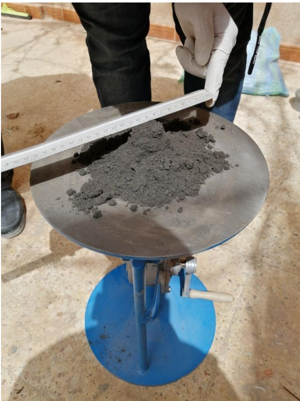
الملحق رقم 7: صورة توضح نهاية تجربة قياس التشغيلية.
