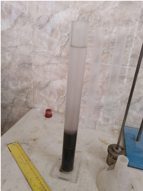
الملحق رقم 3: صورة توضح تجربة المكافئ الرملي.
