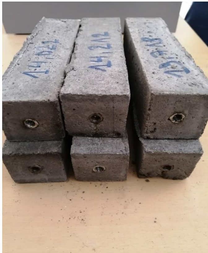
الملحق رقم 12: صورة توضح عينات خاصة بتجربة قياس الانكماش.
