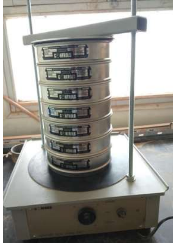
الملحق رقم 5: صورة توضح تجربة التدرج الحبيبي.
