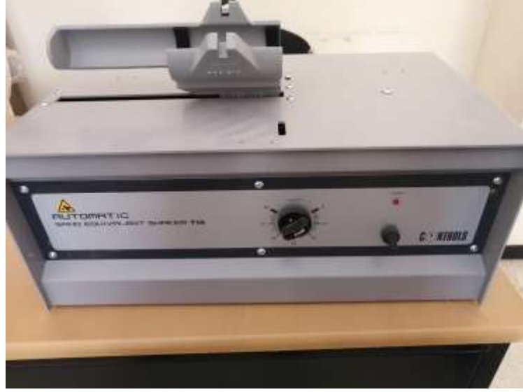
الملحق رقم 4: صورة توضح جهاز اهتزاز عينة تجربة المكافئ الرملي.
