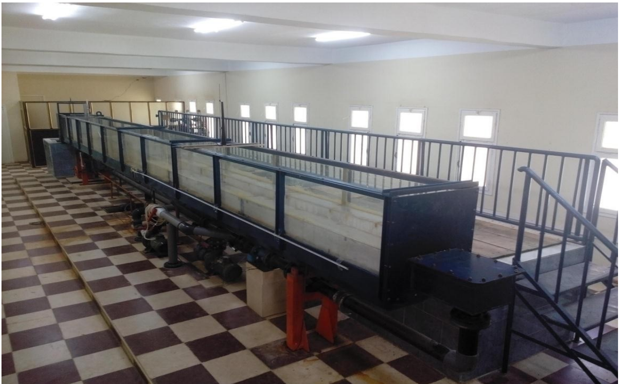
Figure IV.1: Schéma simplifié du canal de mesure en forme rectangulaire composé
