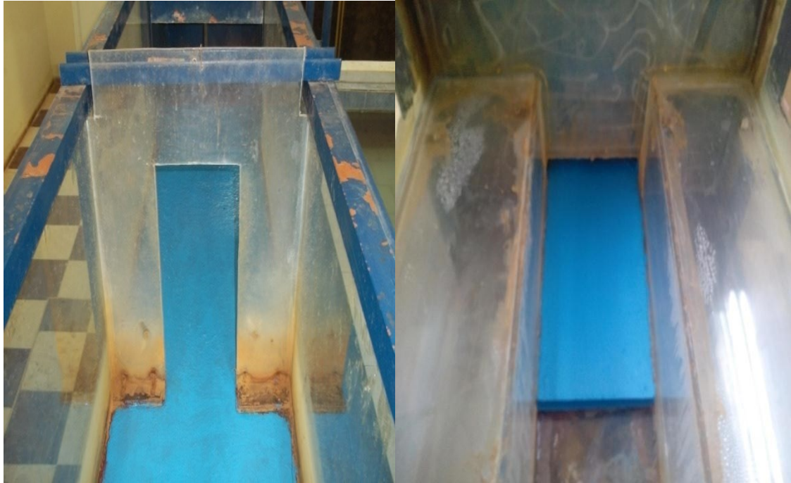
Photo IV.4 : Section de contrôle
