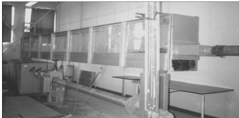
Photo II.1: Dispositif expérimental ayant servi à l'étude du ressaut contrôlé par un seuil dans un canal rectangulaire.
