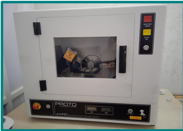
جهاز حيود الأشعة السينية طراز PROTO MANUFACTURING
