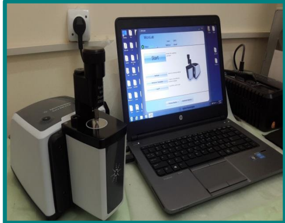
مطيافية الأشعة تحت الحمراء بتحويل فوريه طراز Agilent Technologies Cary 630 FTIR
