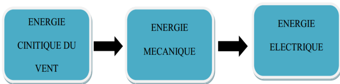
Figure(I-1): Conversion de l'énergie cinétique du vent
