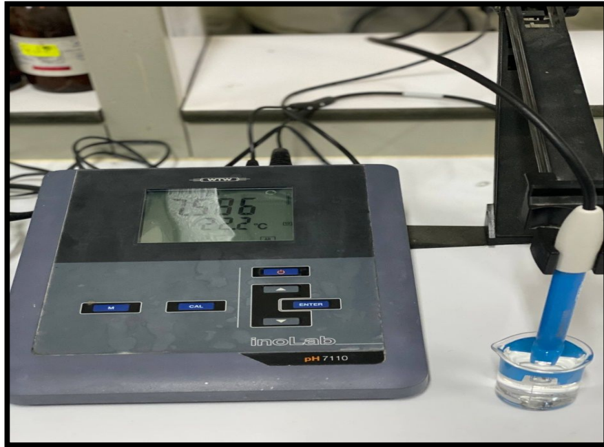
Figure 07 : PH-mètre utilisé pour la mesure du pH des échantillons.
