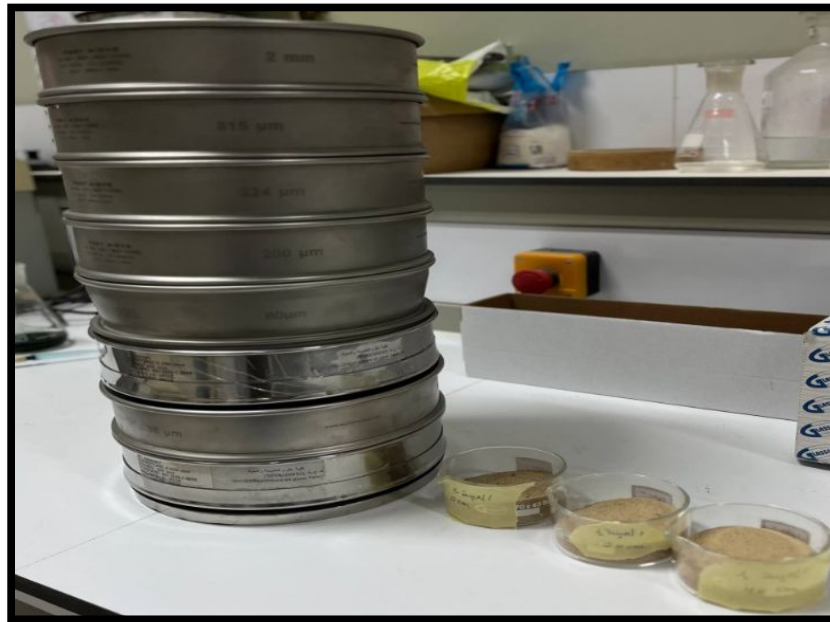
Figure 14 : Série de tamis normalisés utilisée pour le tamisage des échantillons de sol.
