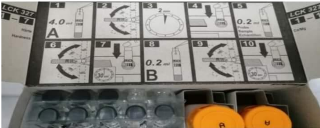
الشكل III-20: صورة لإختبارات LCK 327 الخاصة بعسر الماء.
