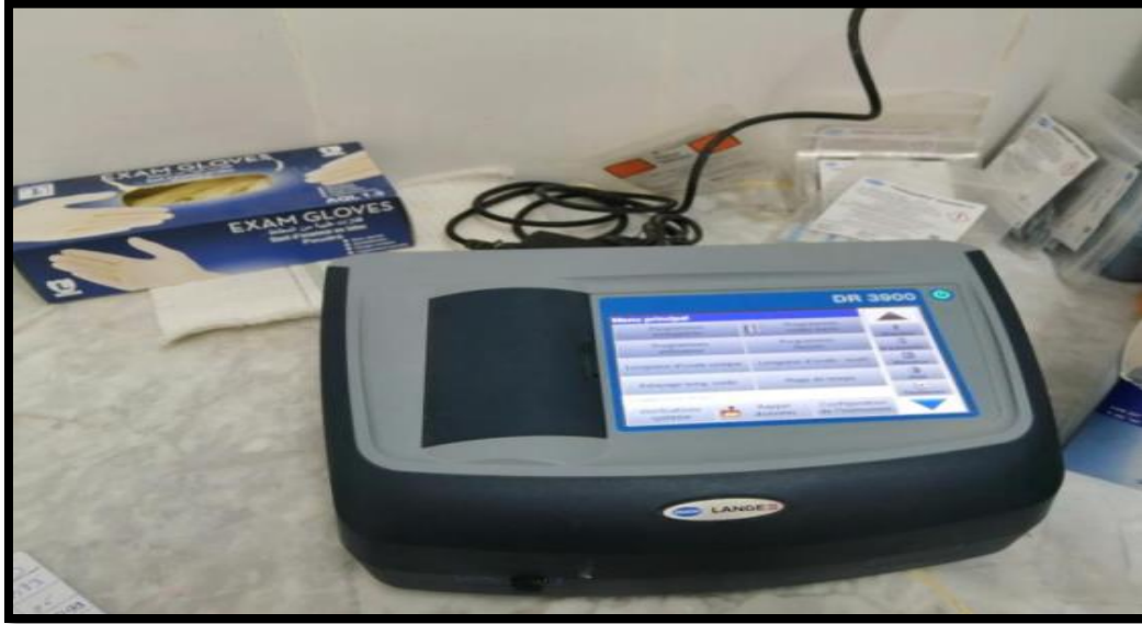
الشكل III-18: صورة توضح جهاز قياس طيف الضوء فوقي .
