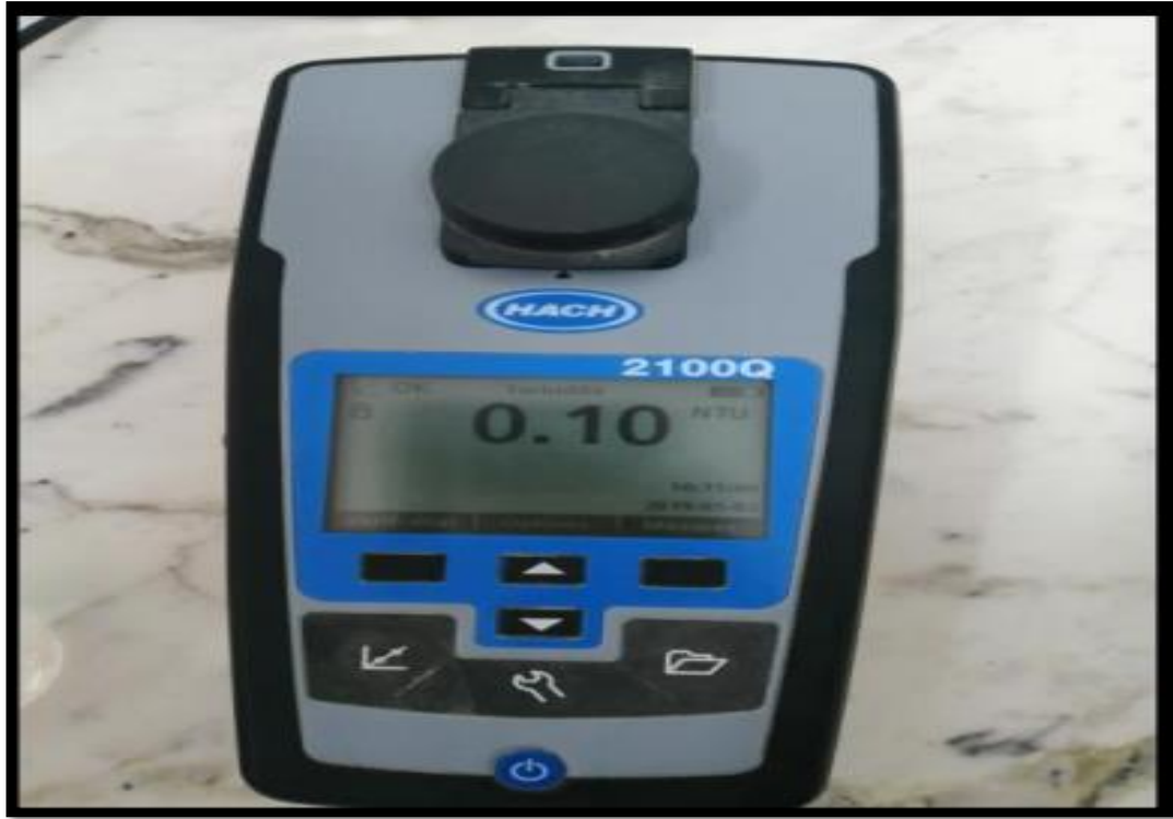
الشكل -III:16 صورة لجهاز قياس العكارة .
