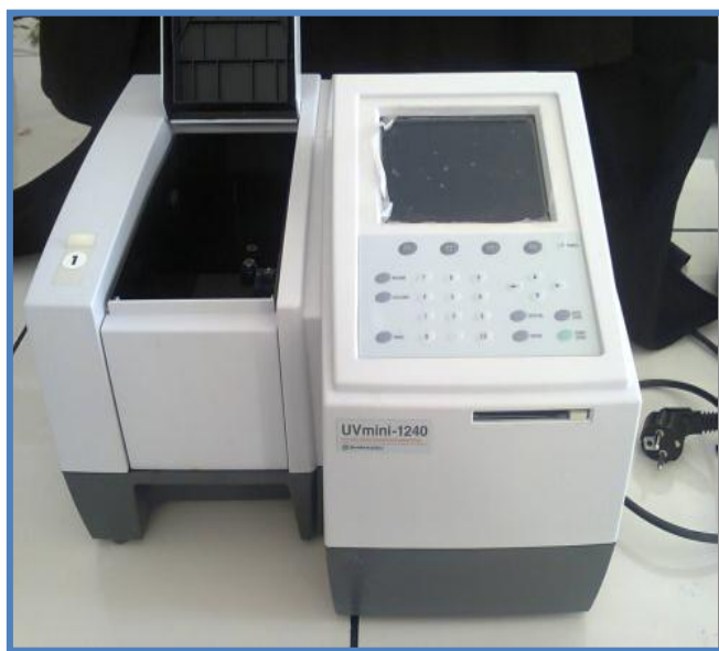
Figure 06: Spectrophotométrie à transmission moléculaire de type UV- VIS -1240 (photo original 2015).
