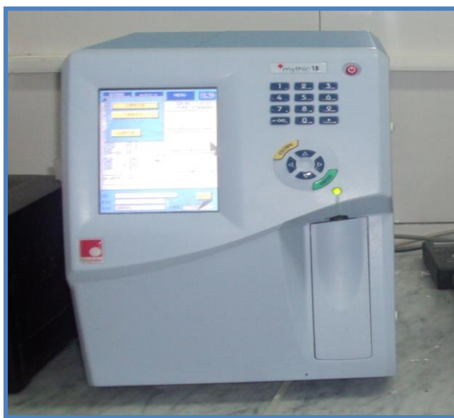
Figure 09: Autoanalyseur pour FNS de type Mythic 18 (photo original 2015).
