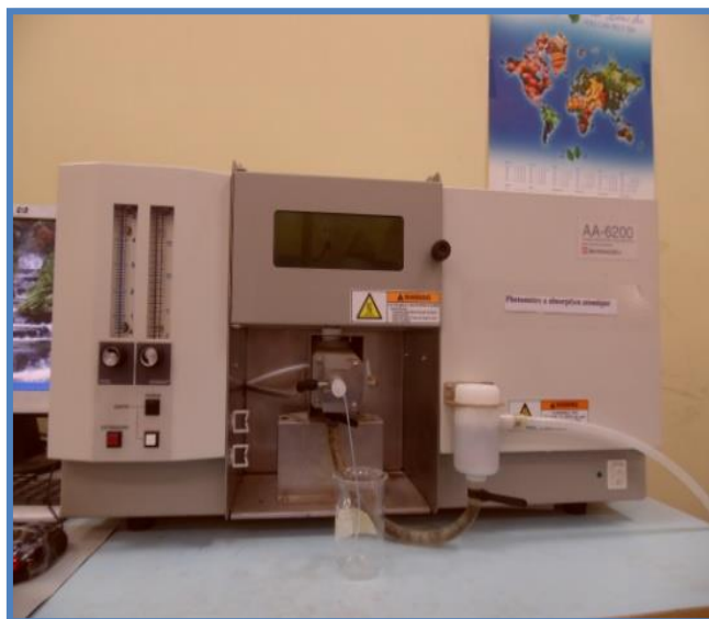
Figure 07: Spectrophotomètre d'absorption atomique de type AA 6200 (photo original 2015).
