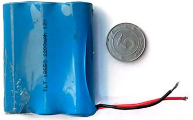
Figure III. 8: Image de la batterie au lithium
