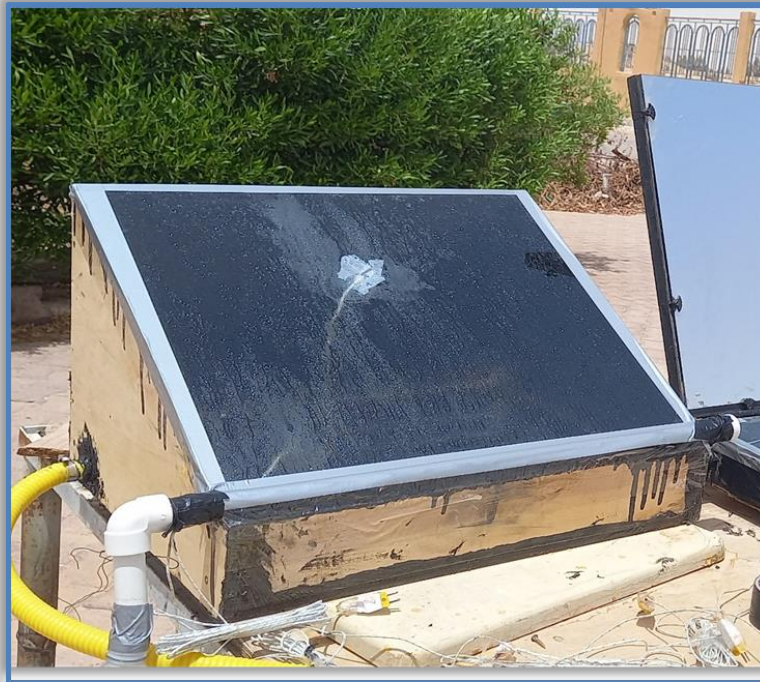
الشكل (3-17): عملية التكثيف داخل المقطر.
