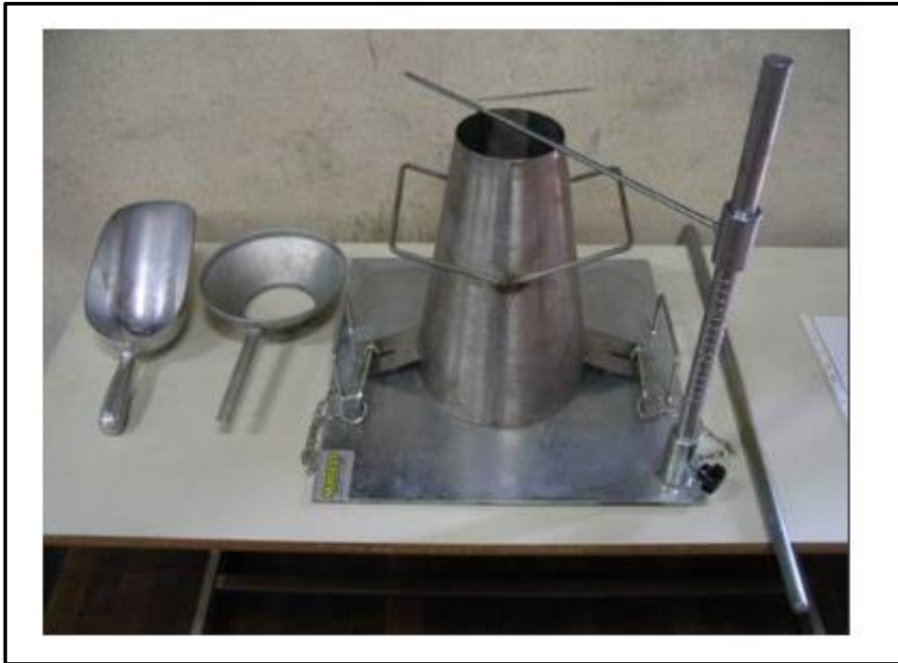
Figure II.19 Matériel requis pour l'essai au cône d'Abrams.
