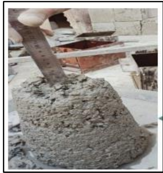
Figure II.20 Principe de la mesure d'affaissement du béton.
